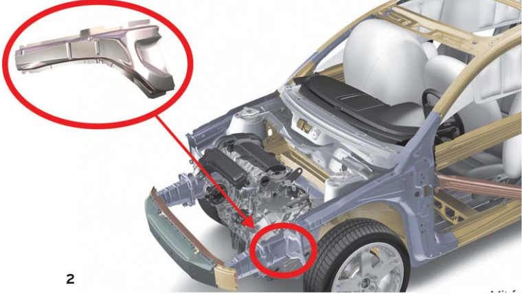
2 _ Volvo setzte Sigma für den vorderen Längsträger am S40/V50 ein. 3 _ Dr. Waldemar Kubli: »Die Designer bildet die Geometrie durch Netztechnologie ab. Die sind so genau, um auf ihnen Prototypwerkzeuge zu fräsen.« 4 _ Jörg Keller sieht in der Kooperation mit AutoForm große Potentiale.
