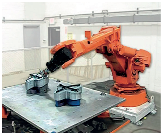
Image 4 : Process de sertissage à molette (Source Autoform)
