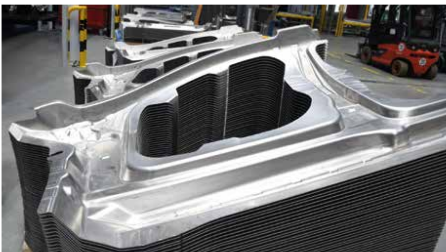
Über 300.000 Teile wurden bislang in Achern-Fautenbach per Aluminium-Hotforming in einem Zug hergestellt - hochfest mit detailreichen Geometrien.
