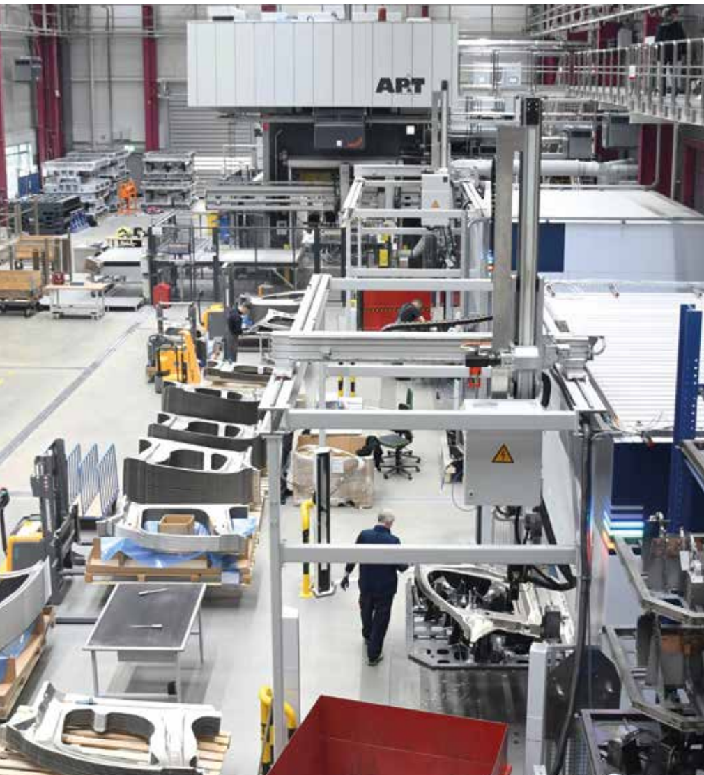
Die Fischer Group betreibt am Standort im badischen Achern-Fautenbach die weltweit erste Großserienlinie für Aluminium-Hotforming.
