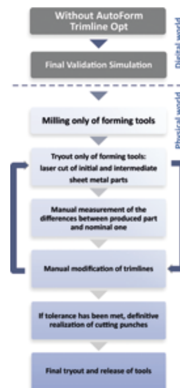
Flusso di lavoro tipico di un'officina per l'ottimizzazione della linea di rifila.
