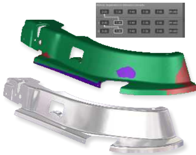
Kompensation der Operation D-20, basierend auf der Rückfederung, die nach der Ziehoperation gemessen wurde. Die Ergebnisse liegen zu 79% in den Toleranzen.
